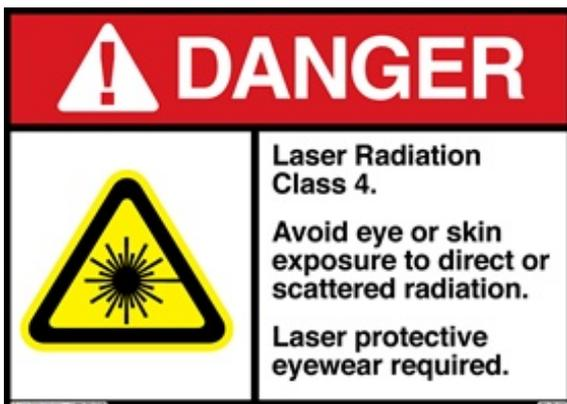
En accord avec la norme EN 60825-1 sur les appareils à laser, ce produit est un laser de Classe 4
